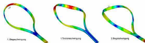
Abb. 4: Eigenschwingungen des Tennisschlägers
