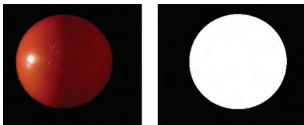
Abbildung 2: Kugeltest-Referenzbild (links) und der erwartete Wert (rechts)
