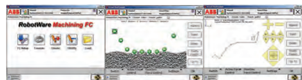
Abbildung 1: Benutzeroberfläche RobotWare FC Machining am Programmierhandgerät (Quelle: ABB)
