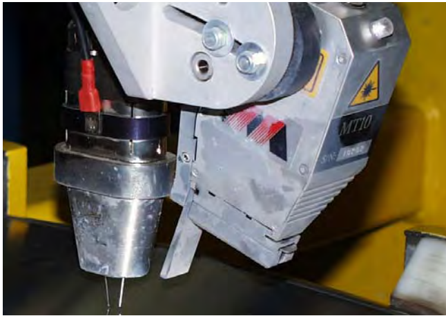
Bild 6. Lasersensor zur offline-Vermessung
